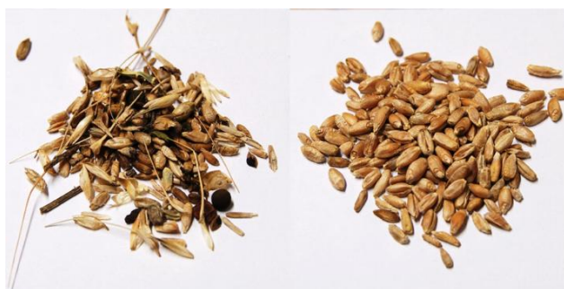
Figure - Grains avant et après tri par un nettoyeur-séparateur sans (pré-)nettoyage (Isla de pan)
