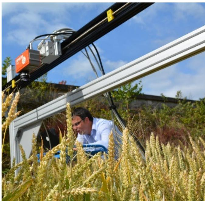
Figure 11.24 – Plateforme de mesure d'imagerie hyperspectrale de terrain.
